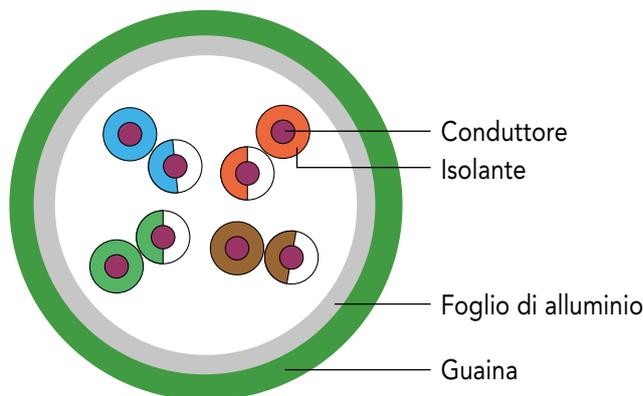
**Cat. 5e** **Shielding F-UTP** **AWG 26/7** **PVC polyvinyl chloride**
